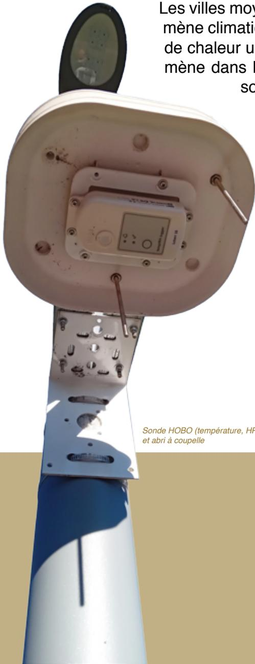
Sonde HOBO (température, HR) et abri à coupelle
