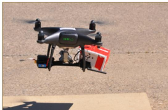
Drone quadricoptère DJI Phantom IV Pro avec caméra optique et caméra thermique FLIR Vue Pro 336 9 mm 35° FOV sous abri anti-radiation (place Mazelle Metz, 14 juin 2021)
