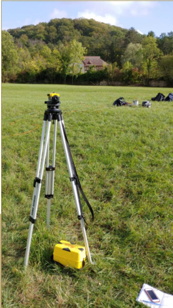
Niveau de chantier optique (opération de nivellement des dépôts sédimentaires)
