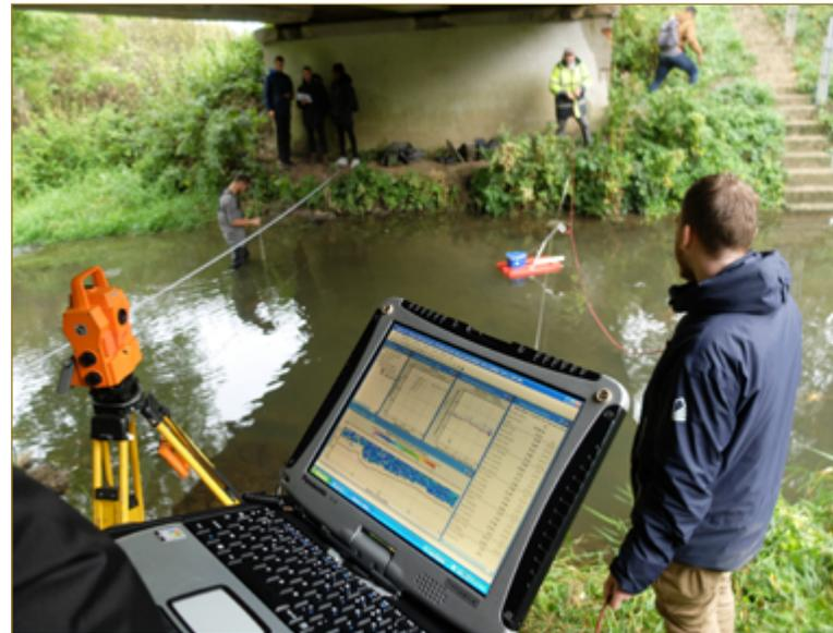
Équipement de terrain pour l'hydrométrie (mesure des débits et des niveaux d'eau dans les cours d'eau) : véhicule de terrain, perches à micromoulinet (vélocimètres), débitmètre aDcp, tachéomètre.
