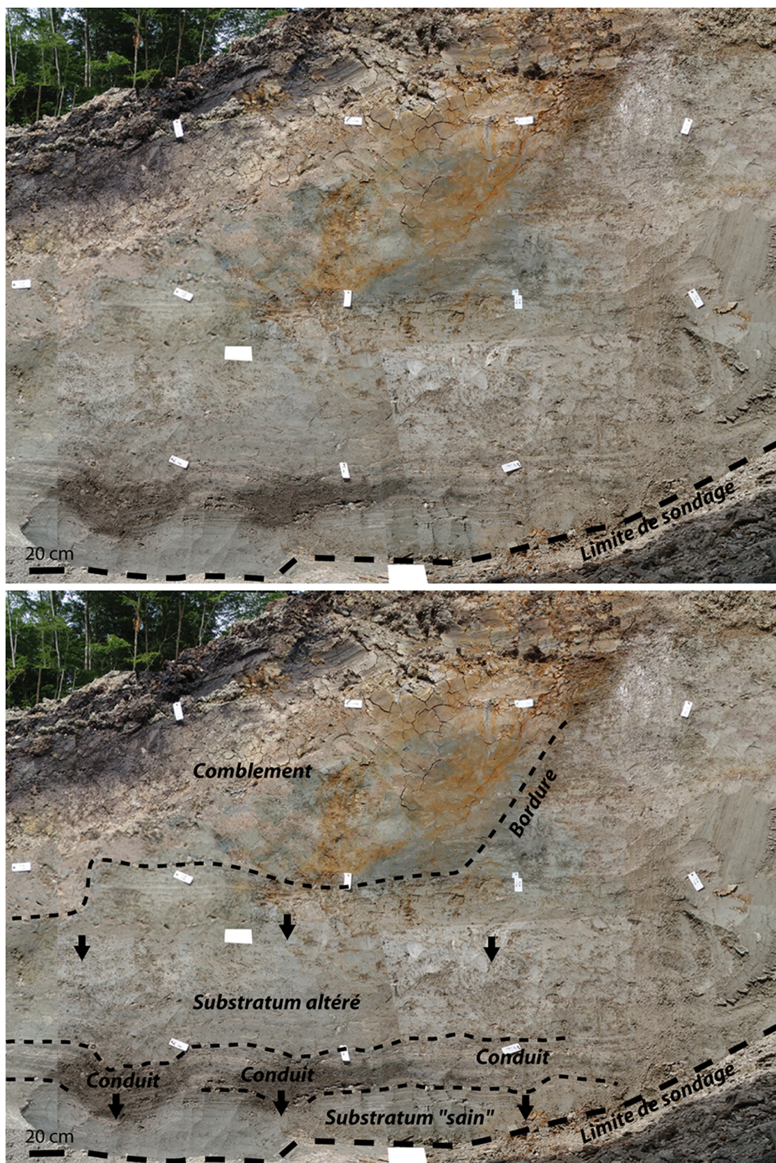
Fig. 7. Mosaïque photographique de la mardelle 5 montrant l'altération et la déformation des marnes attestant leur soutirage en profondeur.
