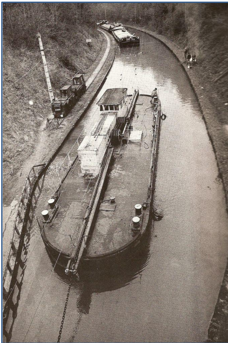
Illustration 4-029 : passage de la traction au toueur à l'entrée de Mauvages [Internet]
