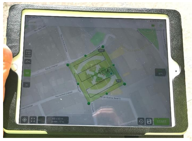
Figure 103 : Vue du plan de vol de la cour Saint-Eucaire via l'interface de l'application Pix4D sur l' iPad ® .
