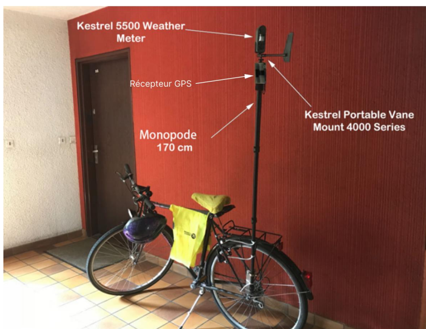
Figure 155 : Vélo équipé de la mini-station météorologique Kestrel 5500 utilisé pour les mesures mobiles sur le territoire de l'Eurométropole de Metz.
