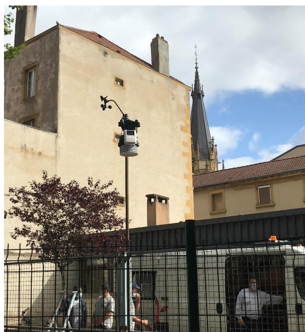
Figure 133 : la station Vantage Pro 2 plus implantée dans la cour de l'école maternelle Saint-Martin.
