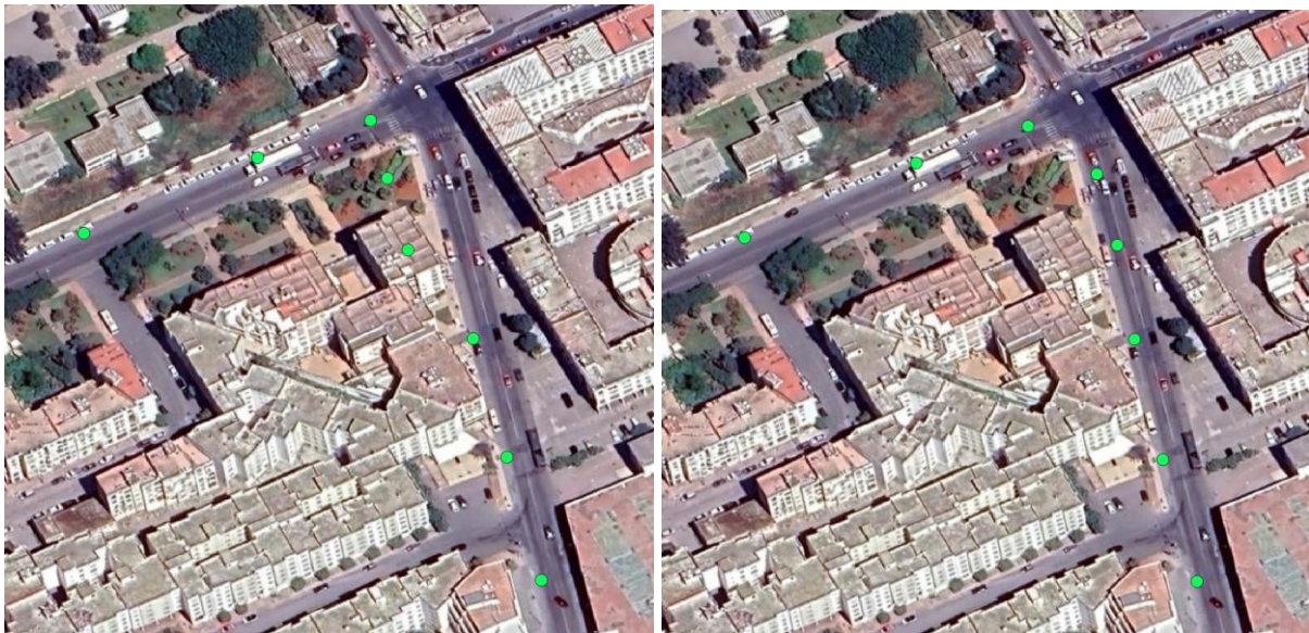
Figure 157 : Erreur de positionnement géographique des points de mesures en ville liée à une rue-canyon (Boulevards Ibnou Sina et Oued Laou à Casablanca).
